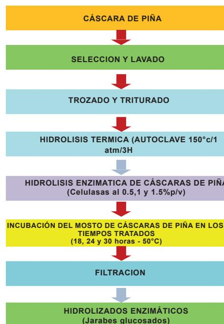
**Figura 1.** Diagrama del proceso de Hidrólisis enzimática aplicado a las cáscaras de piña.
